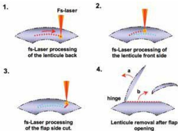
Fig 2 Schéma du Flex® en 3D
